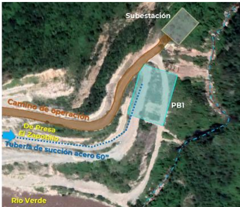
Figura 3.4 Esquema de Planta de Bombeo No. 1 (PB1)
