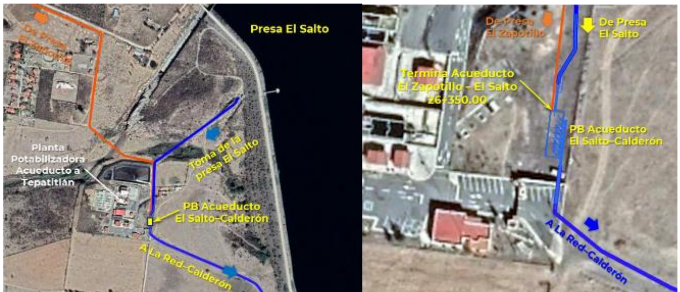
Figura 3.3 Interconexión del Acueducto El Zapotillo–El Salto con El Salto–Calderón
